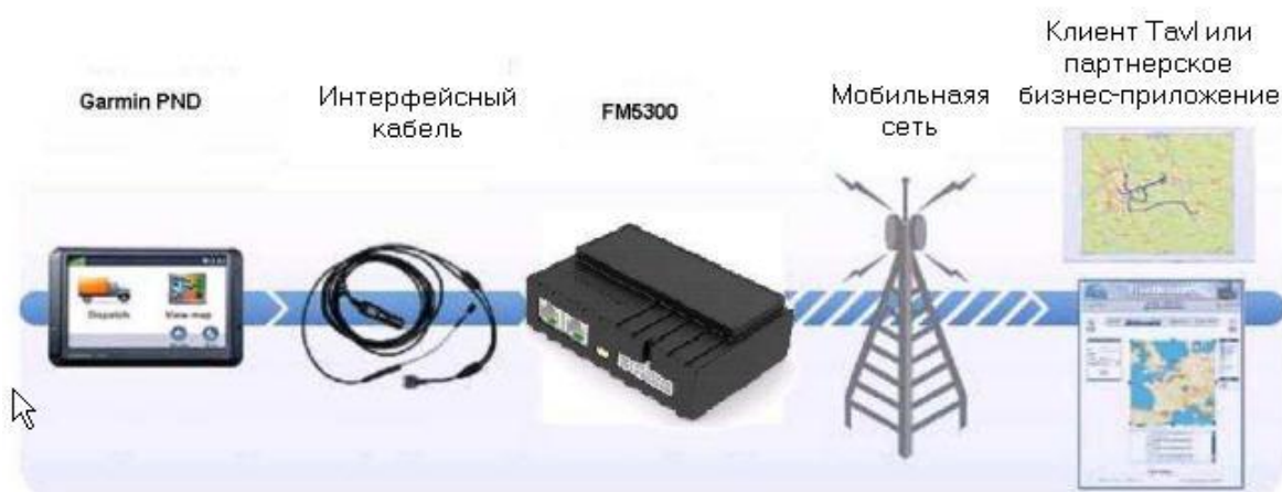
Рисунок 59 Схема работы FM5300+Garmin
